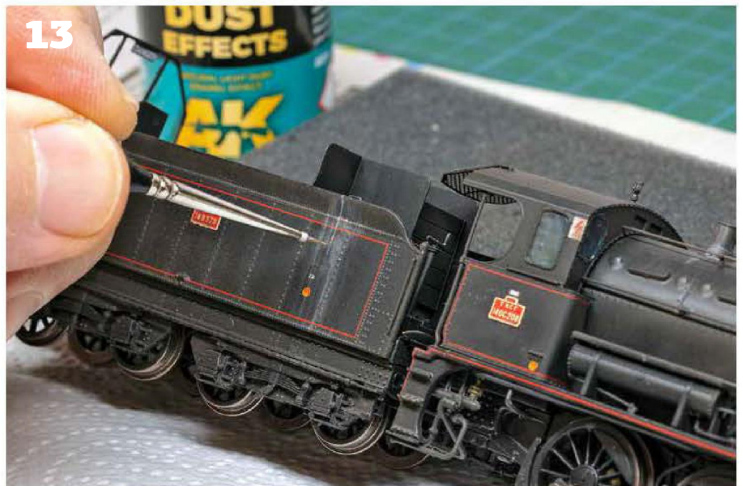
12 Après atténuation des traces blanches à l'aide d'un pinceau plat imbibé de white-spirit, application d'un voile de patine à l'aérographe (avec une buse fine: 0,2 mm par exemple) : crasse (Decapod 8255) sur l'ensemble et noir sale (Decapod 8253) sur la partie supérieure.
