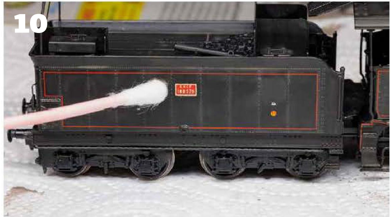
10 Possibilité d'atténuer certaines zones à l'aide d'un coton-tige, en lustrant par exemple les tôles des flancs du tender.
