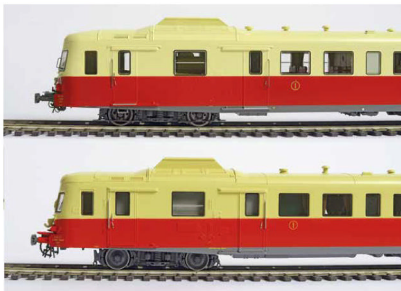
REE en haut, Roco en bas. Le modèle Roco est un peu haut sur « pattes » et est surtout pénalisé par les baies opaques dissimulant le moteur.
