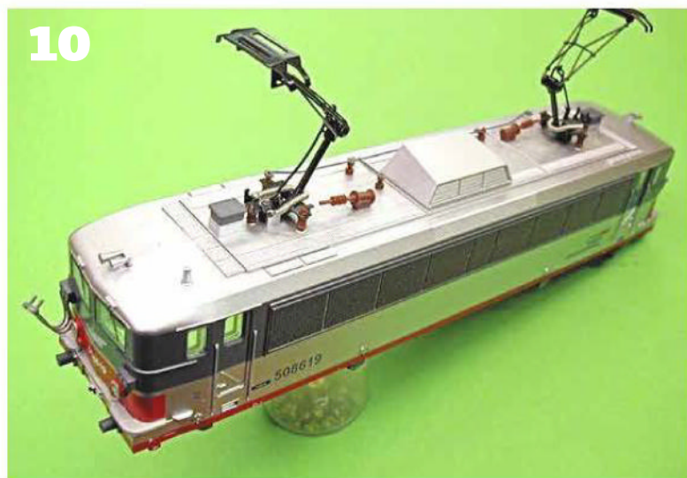
10 La 8619 d'origine : les pantos sont grossiers et faux, ainsi que la ligne de toiture, dotée de mauvais isolateurs... Mais la livrée est bien appliquée et intacte !
