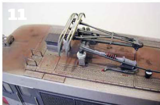
10 La 8619 d'origine : les pantos sont grossiers et faux, ainsi que la ligne de toiture, dotée de mauvais isolateurs... Mais la livrée est bien appliquée et intacte !
