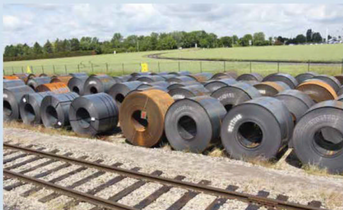
Exemple de stockage, à même le sol, de coils en attente de transformation. Remarquez les différences de diamètre et d'effets de corrosion.
