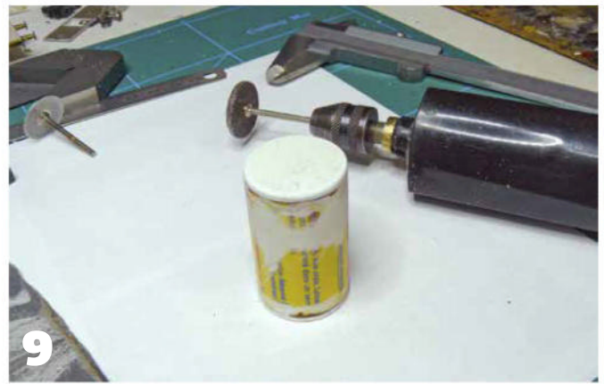
9 Après collage, les extrémités sont mises en forme.
