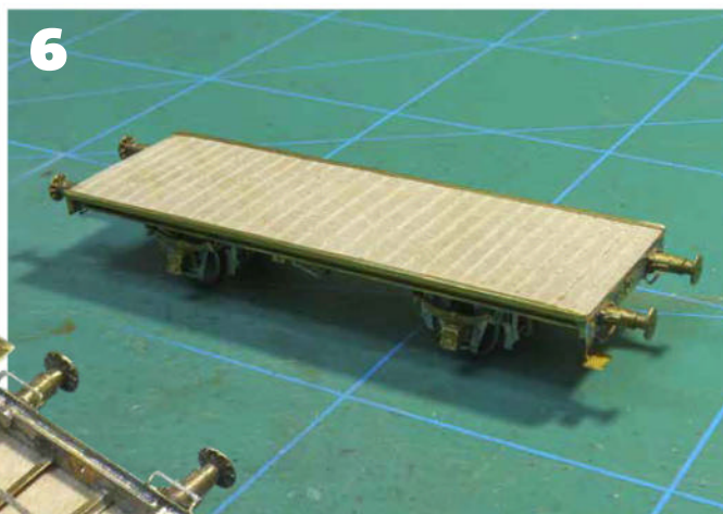
6 Un plancher de bois rainuré recouvre le châssis.
