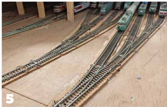
Les aiguilles de sortie des garages sont talonnables.
