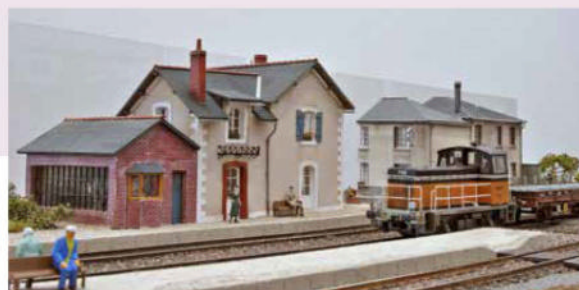
Un train de travaux traverse la gare de Neau, qui n'a pas encore sa plaque. Un plan de voie simple, autorisant quelques manœuvres sur un module de 30 cm de largeur.
