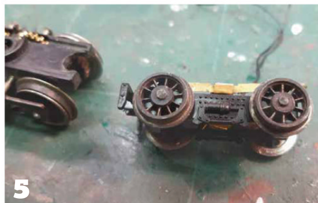
6: Le bogie porteur est doté de lames de prise de courant, et d'un timon de liaison en laiton.
