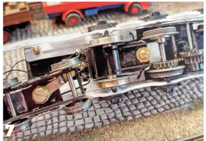
7: Vue de dessous du châssis moteur, muni du bogie porteur.
