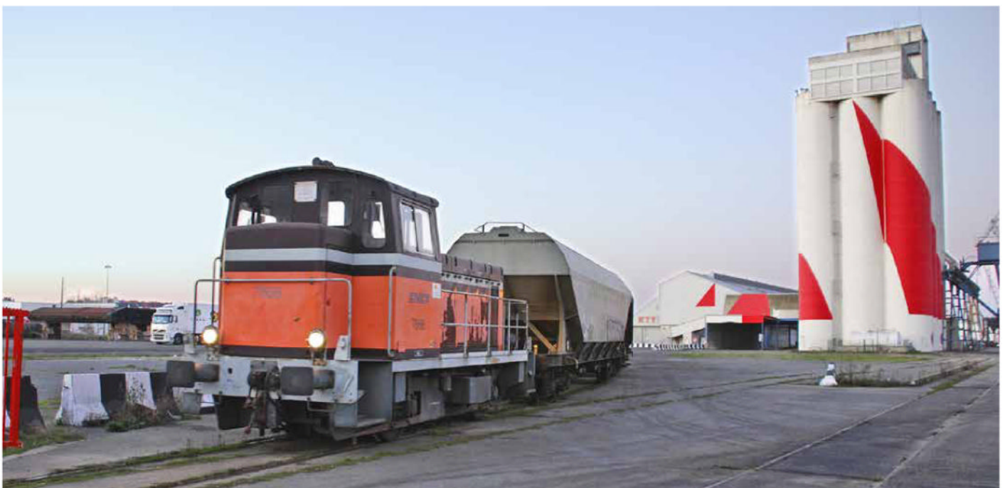
Aux pieds des silos, les rames de wagons-trémies manœuvrent. Chaque wagon doit passer sous la goulotte de chargement. Un locotracteur est dédié à cette opération répétitive.
