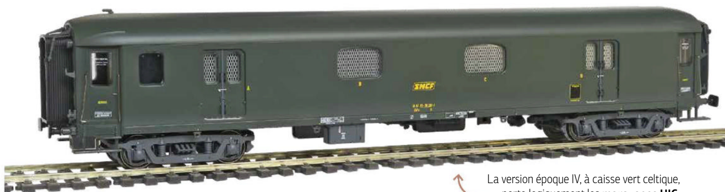
La version époque III, à flancs de caisse vert extérieur et toit noir, comporte encore le périscopie en toiture .
