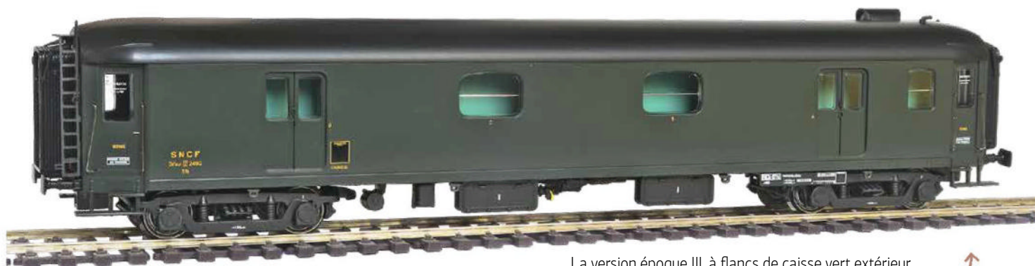
La version époque III, à flancs de caisse vert extérieur et toit noir, comporte encore le périscopie en toiture .
