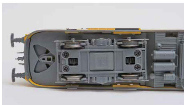
Le bogie moteur, très compact, équipera d'autres autorails unifiés .
