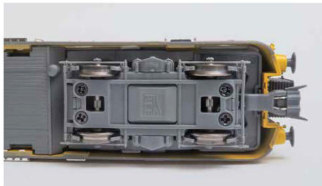
Le bogie porteur de l'élément moteur capte aussi le courant .
