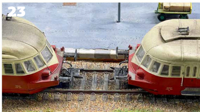
23 Un attelage REE conducteur équipe aussi ces deux autorail Renault ABJ4. Il leur permet de circuler en jumelage de façon très sûre.
