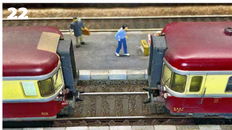
22 Les remorques des deux RGP 1 Roco possèdent un attelage conducteur : en rame homogène à quatre caisses, tous les éléments de la rame sont alimentés et partagent la prise de courant.
