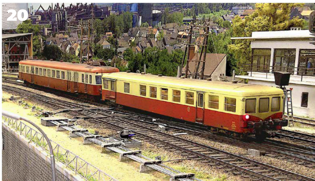
20 Cette remorque Decauville attelée à un X 2400 est équipée, comme le reste du parc autorail, d'attelages conducteurs et d'une ligne de train. Elle participe donc à fiabiliser le fonctionnement de la motrice tout en présentant un éclairage de la salle et des feux de fin de convoi à chaque extrémité. Un décodeur de fonction assure leur contrôle.
