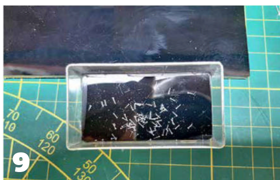
9 Astuce : une plaque de PVC noire, ou de papier Canson, permet de mieux visualiser les rivets transparents, manipulés avec des brucelles à becs fins.
