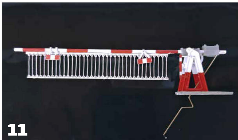
11 L'articulation des barrières se fait via une tringle en laiton de 0,5 mm de diamètre mise en forme en suivant le gabarit fourni.
