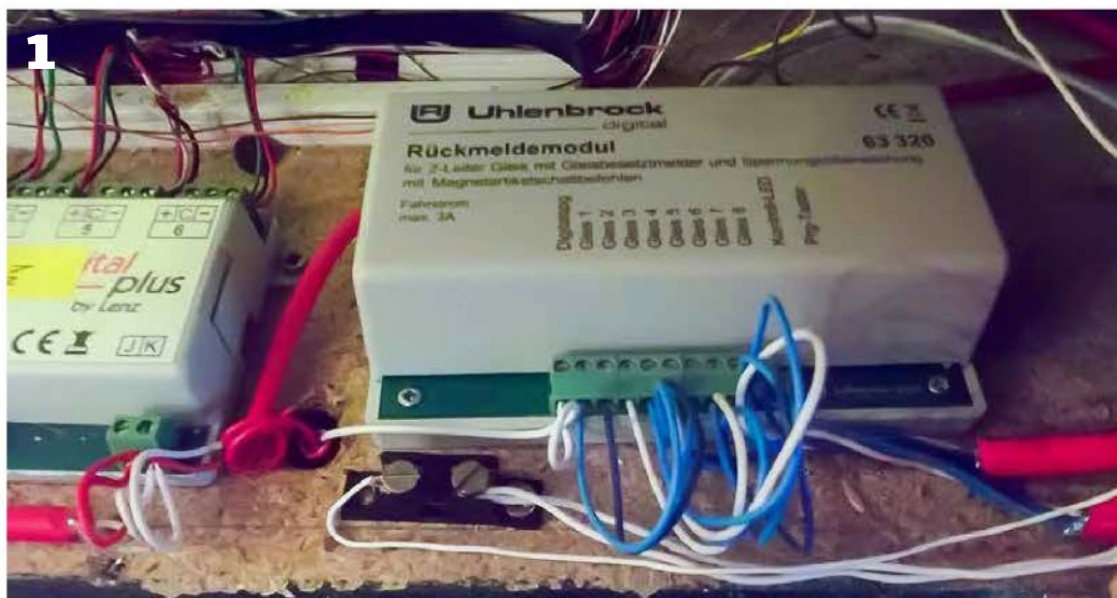
Module de rétrosignalisation Uhlenbrock qui permet la surveillance de huit zones, par détection de consommation de courant.
