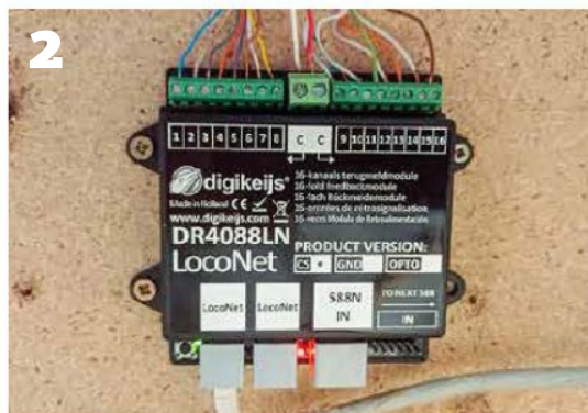
Module de rétrosignalisation de la marque Digikeijs qui permet la surveillance de seize zones réparties en deux groupes de huit. Vous avez la possibilité de combiner deux sources d'arrivée (centrale et booster par exemple).
