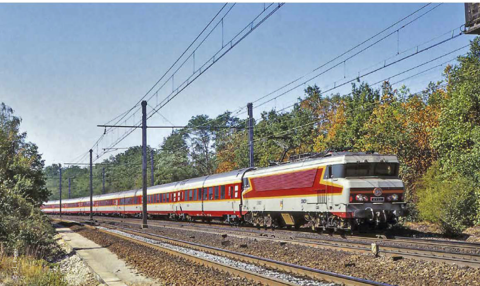
La CC 6521 à Étampes en août 1990. Sur la locomotive comme sur les voitures, le gris ciment a remplacé le gris inox.
