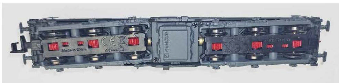
Tous les essieux sont moteurs, deux roues sont bandagées.
