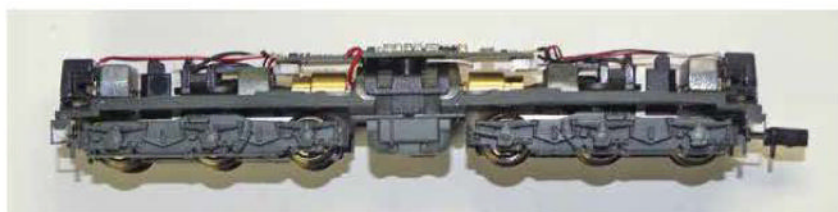
Le châssis technique, mis à nu, sans la superstructure alliant métal et plastique.
