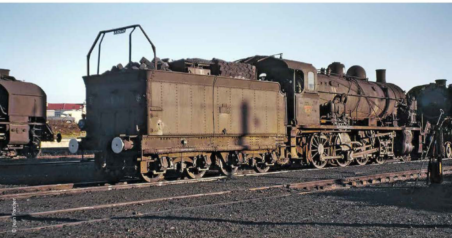
Vue à Reims en 1962, la 1-140 C 246, une locomotive ex-Ouest équipée d'un réchauffeur Dabeg, nous montre l'arrière de son tender.
