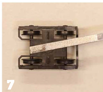
6 L'épaisseur des reliefs du châssis est à réduire.
