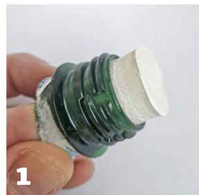
Démoulage du cylindre de base.
