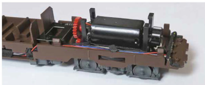
La transmission fait appel à des roues dentées au fonctionnement bruyant.
