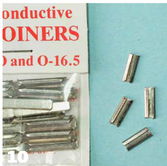
10 Raccourcissement des éclisses métalliques, en ne conservant que la partie centrale, d'une longueur de 8 mm
