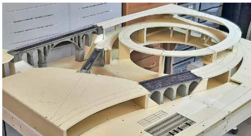
5 - À un stade plus avancé, nous voyons que les différents niveaux sont prêts pour accueillir les voies. Les plateformes supérieures sont découpées dans des panneaux de Xyltech de 5 mm d'épaisseur, ce qui offre suffisamment de rigidité.
