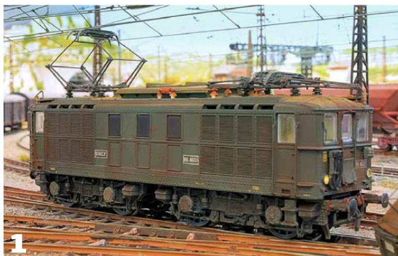
1 Les pantographes Pennati en place: plus rien à voir avec les éléments Sommerfeldt.
