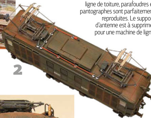
1 Les pantographes Pennati en place: plus rien à voir avec les éléments Sommerfeldt.
