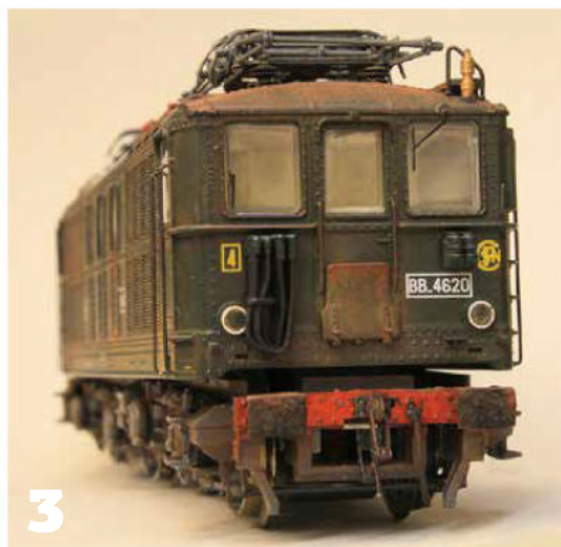
3 Un ancien détaillage de face avant: il est d'un autre âge. Bien des choses sont à revoir, notamment l'affreux boîtier. La caisse est aussi trop haute: un travail pour plus tard.
