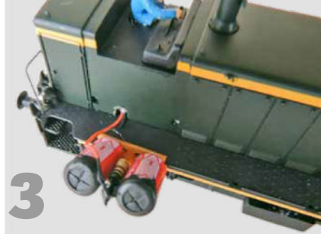
La réserve d'énergie prend place contre le flanc de cabine.
