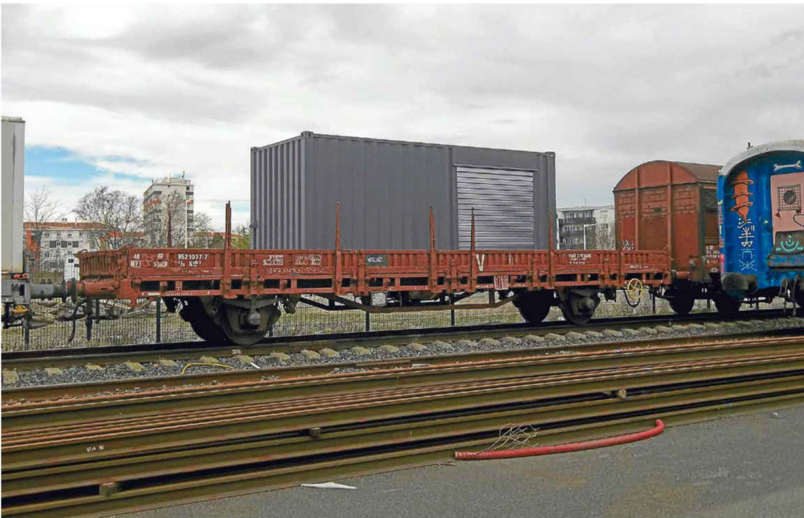
Un wagon plat K50, immatriculé Us de SNCF Réseau, ex-Infra, avec son conteneur (Perpignan, avril 2018).
