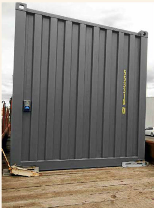
Gros plan sur la prise et les cornières de maintien.
