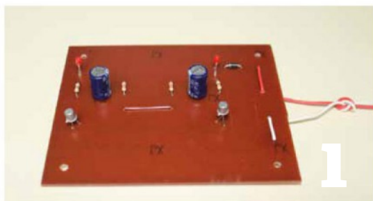
Un clignoteur à composants discrets (1 diode, 2 LED, 4 résistances, 2 condensateurs et 2 transistors).
