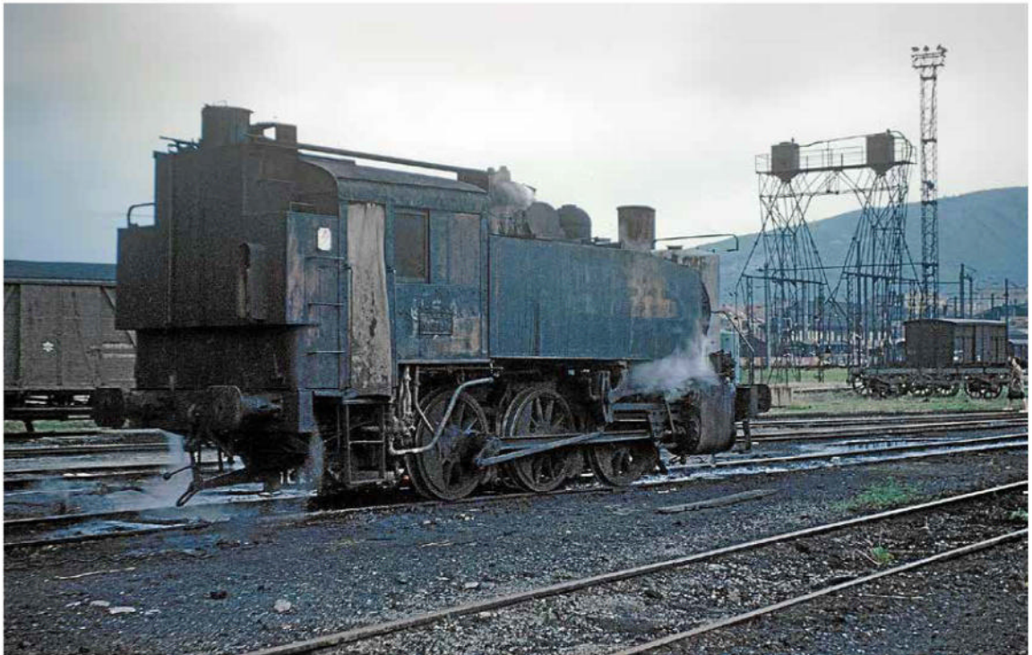
La 030 TU 74 a été convertie à la chauffe au fuel (Annemasse)
