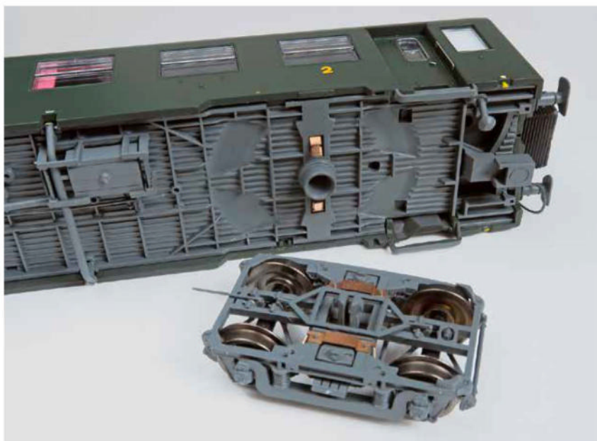
Des plaques de chrysocale accueillent les points d'essieux et transmettent le courant électrique à la caisse.
