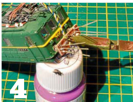
Méthode sans risque pour centrer et souder les LED bien en place.
