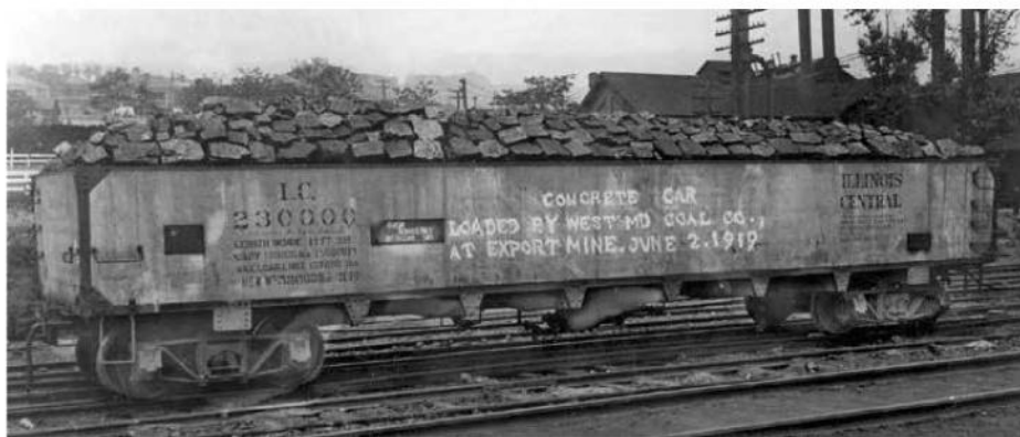
Gondola en béton armé fabriquée pour l' Illinois Central .
