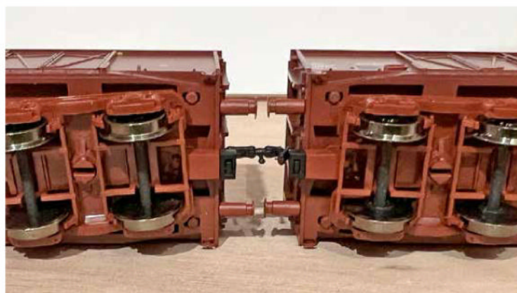
L'ensemble des deux têtes et de la barre mobile forme un timon rigide entre deux wagons .
