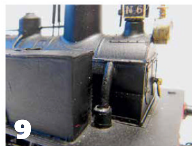
Gros plan sur les conduits de vapeur.
