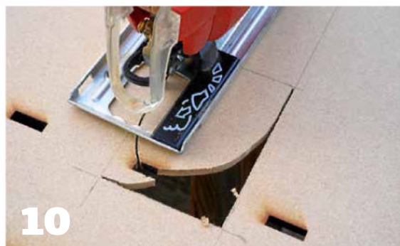
10: La scie sauteuse est l'outil le plus pratique pour créer les ouvertures en bout de module. Notez que mon ouverture est plus basse que le niveau 0 prévu, visible par la position des mortaises.
