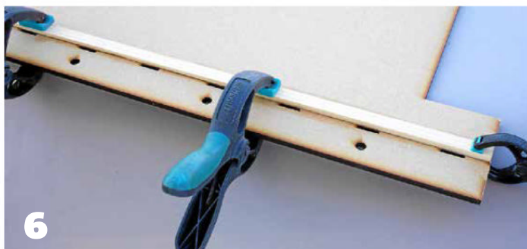
6: Une baguette de 5 x 10 mm de récupération suffit à maintenir le plateau du toit au bon niveau en s'alignant sur le bas des mortaises.
