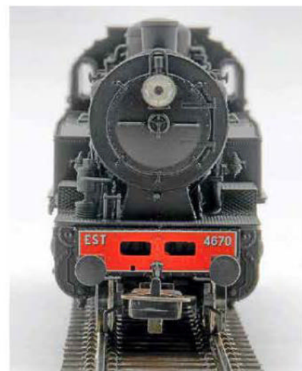
À l'avant, une lanterne Est . Il manque les supports de lanterne sur la traverse.
