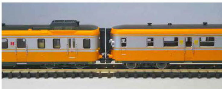
L'accouplement fait appel à des attelages magnétiques .
