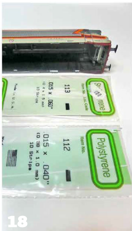
18: Contre les flancs de caisse, à l'intérieur, collage de bandes de carte plastique.
