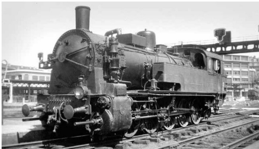
La 2-050 TB 1 en gare de Paris-Nord en mai 1948. Il s'agit d'une T16 0 reconnaissable à sa soute à eau différente et à son 4 e essieu moteur.
