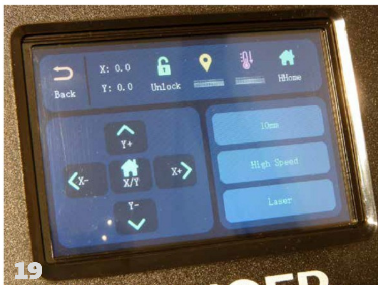
19 : Le menu « Contrôle » est très utile pour valider le fonctionnement de la graveuse. On va ainsi pouvoir tester le laser et les mouvements suivant l'axe X et Y.
