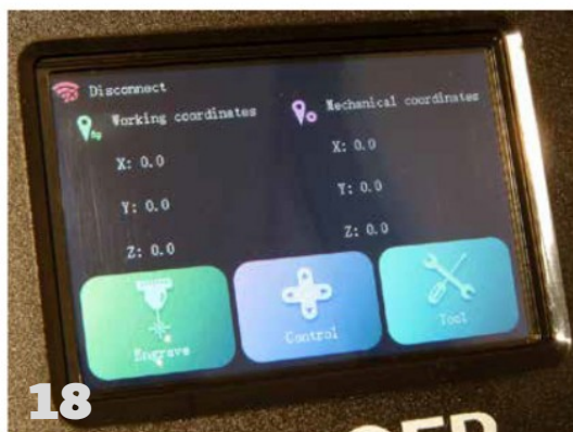
18 : L'interface n'existe malheureusement pas en français. Le logo en haut à gauche nous informe que le wifi est déconnecté. Les coordonnées du laser sont indiquées. Curieusement, les coordonnées sont affichées en double sans différences notables. A noter aussi des coordonnées sur l'axe Z qui n'est pas motorisé. Étrange.
