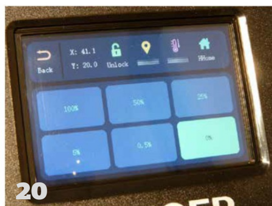
20 : Le laser peut être allumé manuellement via le bouton « laser ». Pour les essais, ne dépassez pas les 0,5 %. C'est suffisant pour voir le point lumineux sur le support à graver mais parfaitement inoffensif pour votre plan de travail.
