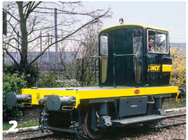
2 Le locotracteur peut transporter jusqu'à 10 tonnes. 67 Moyse BL seront produits de 1966 à 1969, déclinés en plusieurs versions, destinés surtout à des embranchements privés.
