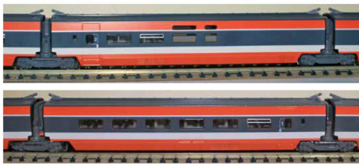
↑↑ La remorque bar , caractérisée par ses flancs en partie sans baies.
