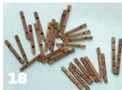
18 Assortiment de traverses, la plupart issues de pleine voie, les deux plus longues issues d'un branchement.
