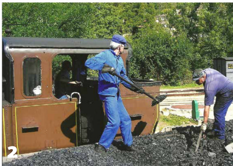
Chargement à la pelle d'une Mallet du Vivarais depuis le quai à charbon de Lamastre. Le travail serait encore plus dur si le charbon était entreposé au niveau du sol.
