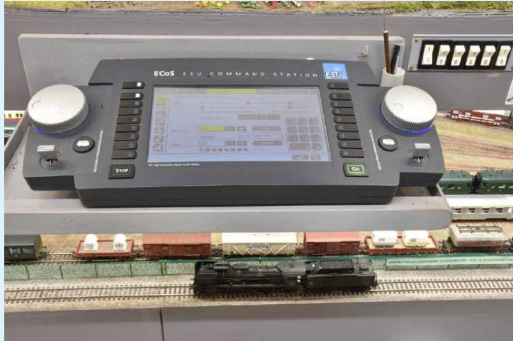
La loco est placée sur la voie du centre d'essais ferroviaires de Beauregard, traduisez, la voie de programmation, pour le paramétrage.
