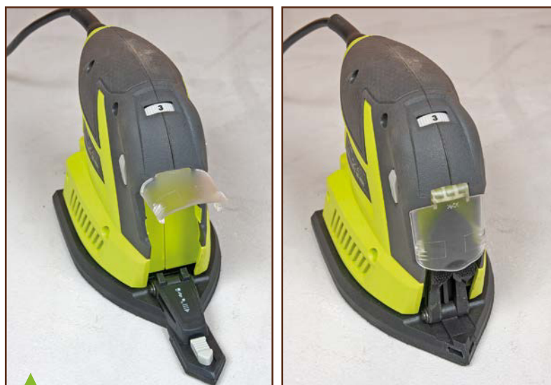
La Ryobi possède aussi un petit patin plat, mais il est indépendant de la semelle principale (quoique fixé dessus) et peut se relever vers le haut de la machine, protégé par un capot en plastique transparent.
