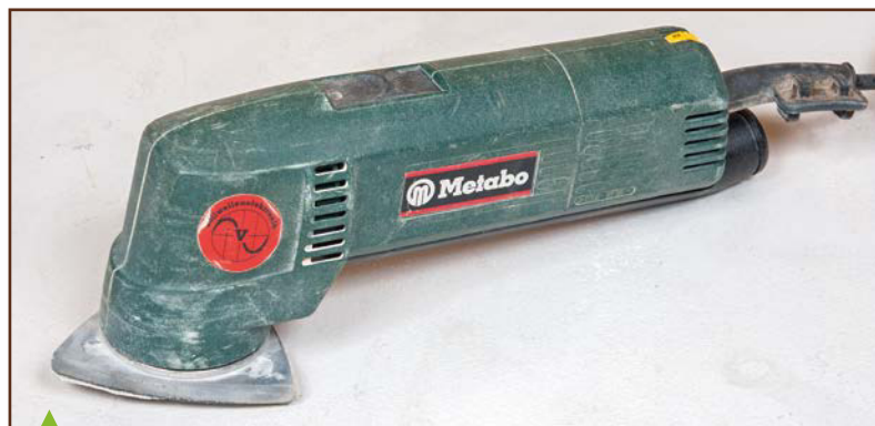
La morphologie des premières machines à patin triangulaire (ici ma vieille Metabo) se fait de plus en plus rare, au profit de formes plus compactes, mais à patin plus grand.
