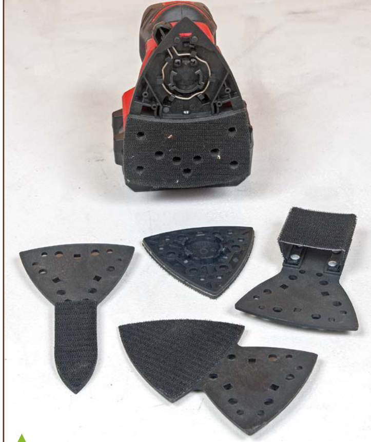
La partie avant de la Skil est amovible pour laisser place à trois patins supplémentaires : un delta de la forme ancienne (mais sans aspiration possible), un patin étroit, et un patin de forme pour poncer des éléments cylindriques.
