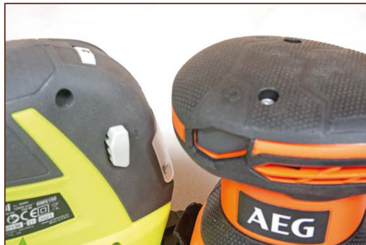
Les interrupteurs de Ryobi et AEG sont des poussoirs transversaux passant de gauche à droite. Je ne les ai pas trouvés particulièrement agréables à manier.
