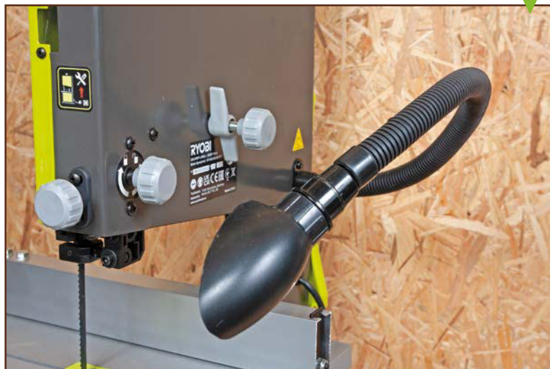
La grande Einhell bénéficie d'un éclairage intégré au boîtier du volant supérieur. C'est beaucoup moins encombrant que la lampe sur flexible de la Ryobi, mais du coup la lampe a tendance à éclairer un peu à côté de la zone prioritaire.
