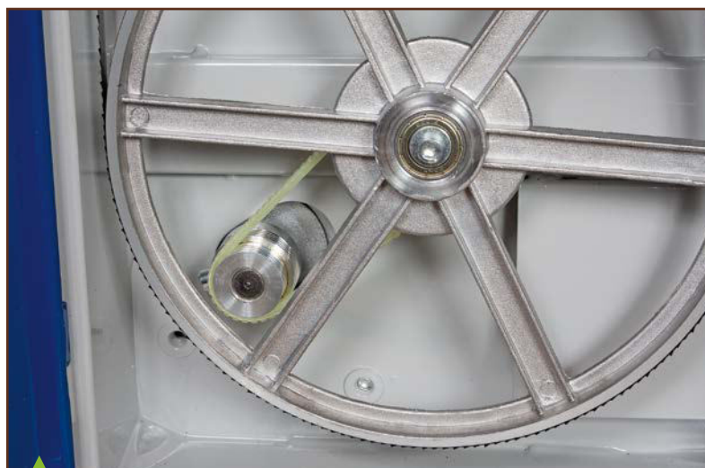
Sur les trois autres machines, l'entraînement se fait par courroie poly-V. Avec, en outre, pour la grande Scheppach, deux vitesses grâce aux poulies doubles.
