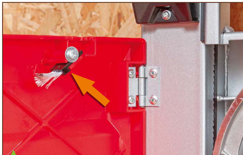
La brosse du volant inférieur de la petite Einhell est intégrée à la porte, une disposition inhabituelle, mais qui semble fonctionnelle.
