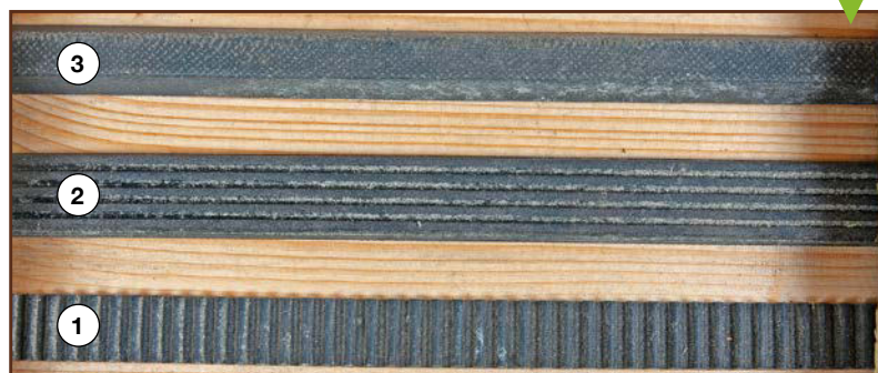
Les courroies d'entraînement se trouvent plutôt dans des outils à moteur transversal, tels que les rabots (en bas) ou les ponceuses à bande [en haut]. Ce sont des courroies dentées/crantées (1) ou des courroies dites poly-V (2). Sur les machines semi-stationnaires, on peut aussi trouver des courroies trapézoïdales (3). Les courroies plates sont plus rares sur les matériels récents. Toutes se trouvent aisément, il existe même des sites internet spécialisés dans les courroies.
