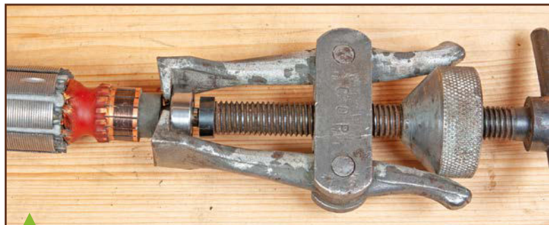
Sur l'arbre, le montage du roulement est généralement assez serré et il est donc préférable d'utiliser un petit extracteur pour les retirer s'ils sont à changer. Pour replacer le roulement neuf, on veillera à ne pas forcer sur la couronne extérieure, mais à l'emmancher en tapant délicatement sur la seule couronne intérieure.
