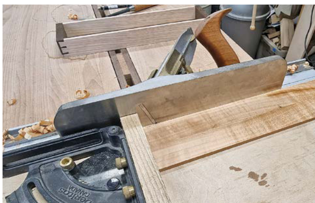
Façonnage de la feuillure au rabot à combinaison.
