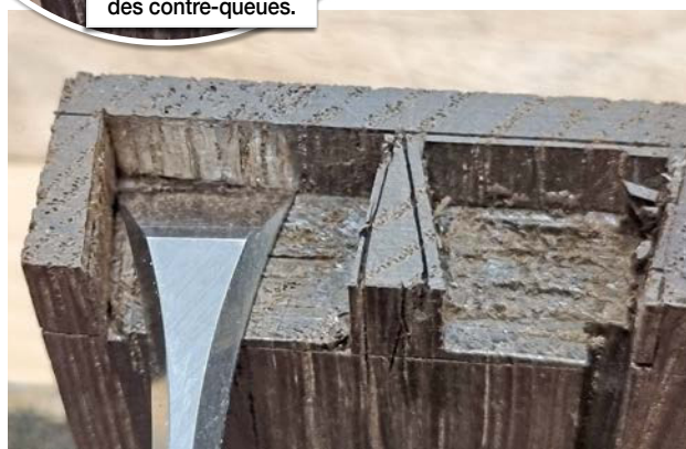
Dégrossissage des contre-queues.
