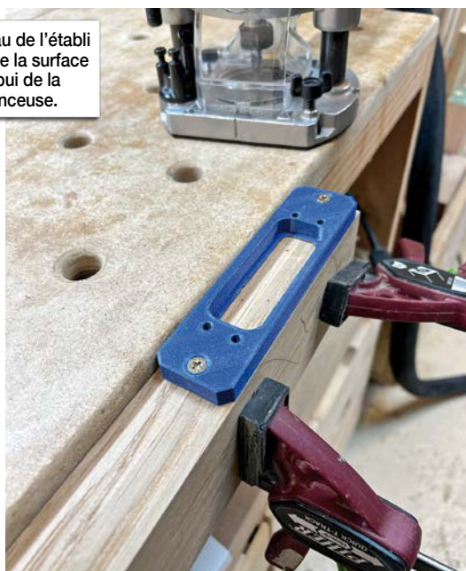
Marquage des trous d'aimant à la pointe carrée) (fait ici avant défonceage des évidements).
