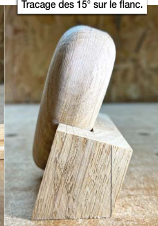
Tracage des 15° sur le flanc.
