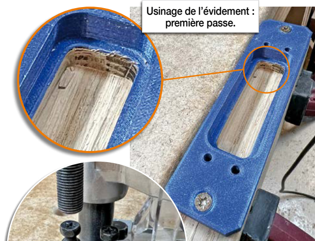
Utilisation de la butée du barillet pour un usinage en plusieurs passes.
