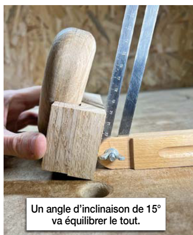
Tracage des 15° sur le flanc.
