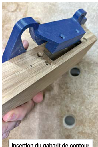
Insertion du gabarit de contour.
