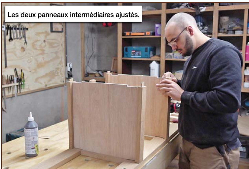
Des entailles dans les angles sont nécessaires pour faire entrer le panneau.
