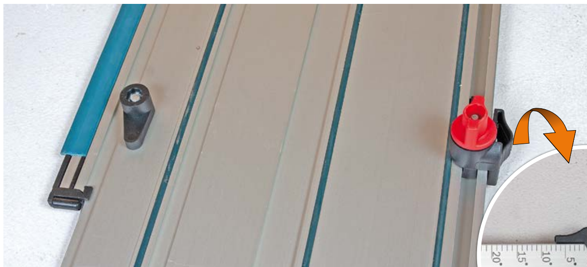
Le contrôle de l'angle se fait au moyen de deux butées situées sous le rail, de part et d'autre. L'une est fixe, l'autre se positionne à convenance en fonction de l'angle souhaité, avec des pré-positionnements à 0, 22,5, 45 et 60°, dans un sens comme dans l'autre.
