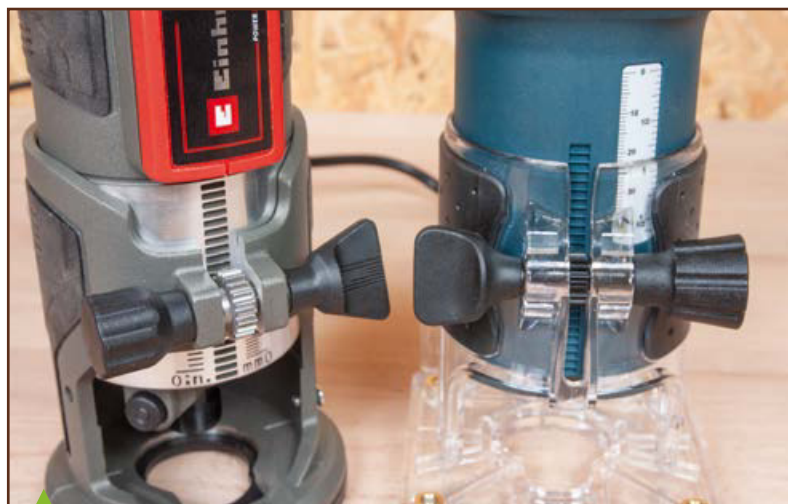
Sur les deux Bosch et la Einhell, le réglage de profondeur s'effectue à l'aide d'un pignon qui s'engrène sur une crémaillère. Une molette (à droite sur la Einhell, à gauche sur les Bosch) permet de desserrer la base, et l'autre (placée à l'opposé de la précédente) agit ensuite sur le pignon.
