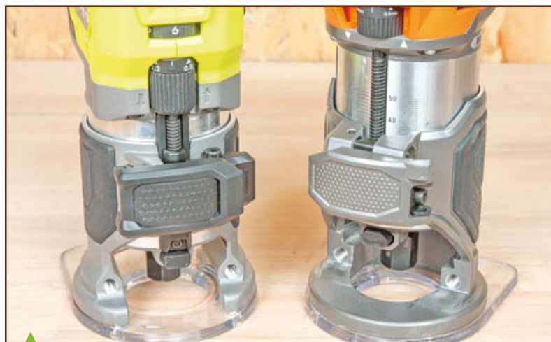
Sur l'AEG et la Ryobi, c'est une vis qui ajuste la montée/descente du moteur dans la base, un système que j'ai trouvé beaucoup plus fluide que le précédent.
